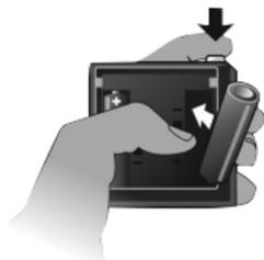
2. Tryk og hold LED-knappen inde, mens du isætter batteriet, indtil lysdioden blinker rødt (ca. 5 sekunder). qheat RS er nu nulstillet til fabriksstandard.
