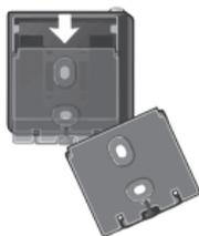
1. Die Rückplatte entfernen, indem Sie sie nach unten schieben.
