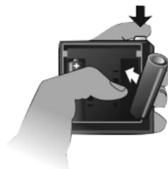
2. Die LED-Taste beim Wiedereinsetzen der Batterie ca. fünf Sekunden lang gedrückt halten, bis die LED rot blinkt. Das qheat RS ist nun auf die Werkseinstellungen zurückgesetzt.
