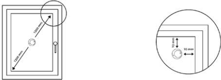
Bei Montage auf einem Tresor sollte sich der Sensor entweder auf der Tür oder auf der Seite, in jedem Fall aber nicht weiter als 2 cm vom Scharnier entfernt befinden.
