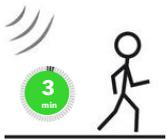
Für eine einfachere Lichtsteuerung und zur Verbesserung der Batterielaufzeit verbleibt der Sensor nach Erkennen einer Erschütterung für 3 Minuten im Zustand "in Bewegung". Der Sensor kehrt 3 Minuten nach der letzten erkannten Erschütterung in den Ruhezustand zurück.
