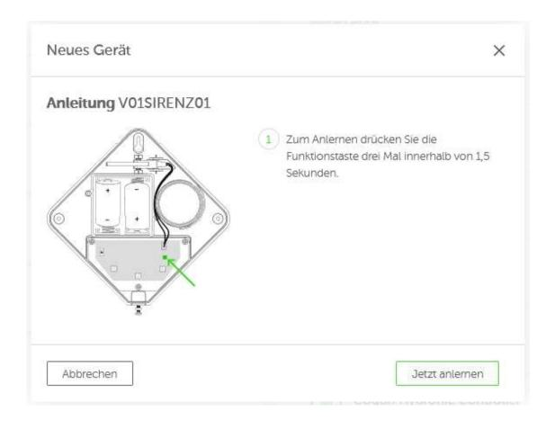
Starten Sie den Anlernprozess. Sobald in der WEB Oberfläche die Anlernzeit anfängt drücken Sie dreimal hintereinander innerhalb von 1,5 Sekunden die Funktionstaste. Eine Bestätigung erfolgt durch Blinken und einen kurzen Signalton. Der Anlernvorgang ist nun beendet und auf der WEB-Oberfläche erscheint das neue Gerät. Sie können die Alarmsirene nun montieren.
